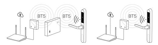
También es posible abrir la puerta con tecnología sin contacto RFID/NFC (presentando una tarjeta válida) y mediante la introducción de un código PIN (teclado capacitivo). Puede emplearse con cerraduras de embutir europeas (DIN). Es la solución perfecta para cualquier tipo de puerta, habitación, oficina, zonas comunes, etc.
