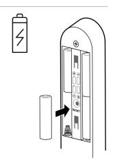
Es posible restaurar la configuración de fábrica, en caso de detectar un mal funcionamiento del dispositivo. Para ello emplear el pulsador de reset (pulsar más de 10 segundos) ubicado en el portapilas (panel trasero).
